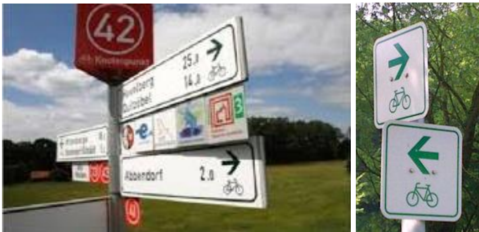
Abbildung 40: Fahnenwegweiser und Zwischenwegweiser
